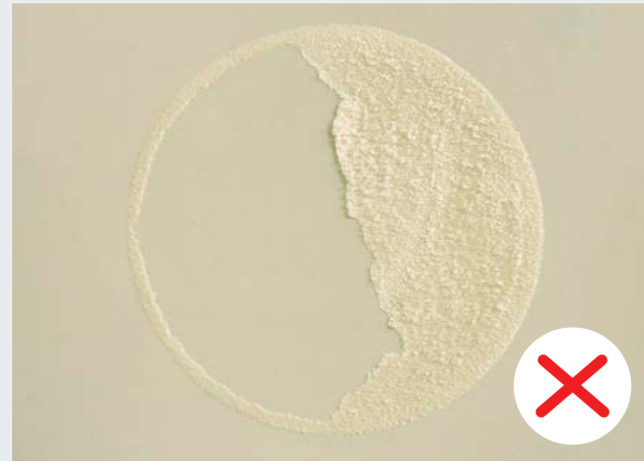
Lớp cách nhiệt bám dính trên sơn mặt sau thông thường Insulation adhesion on conventional pre-painted steel backer
