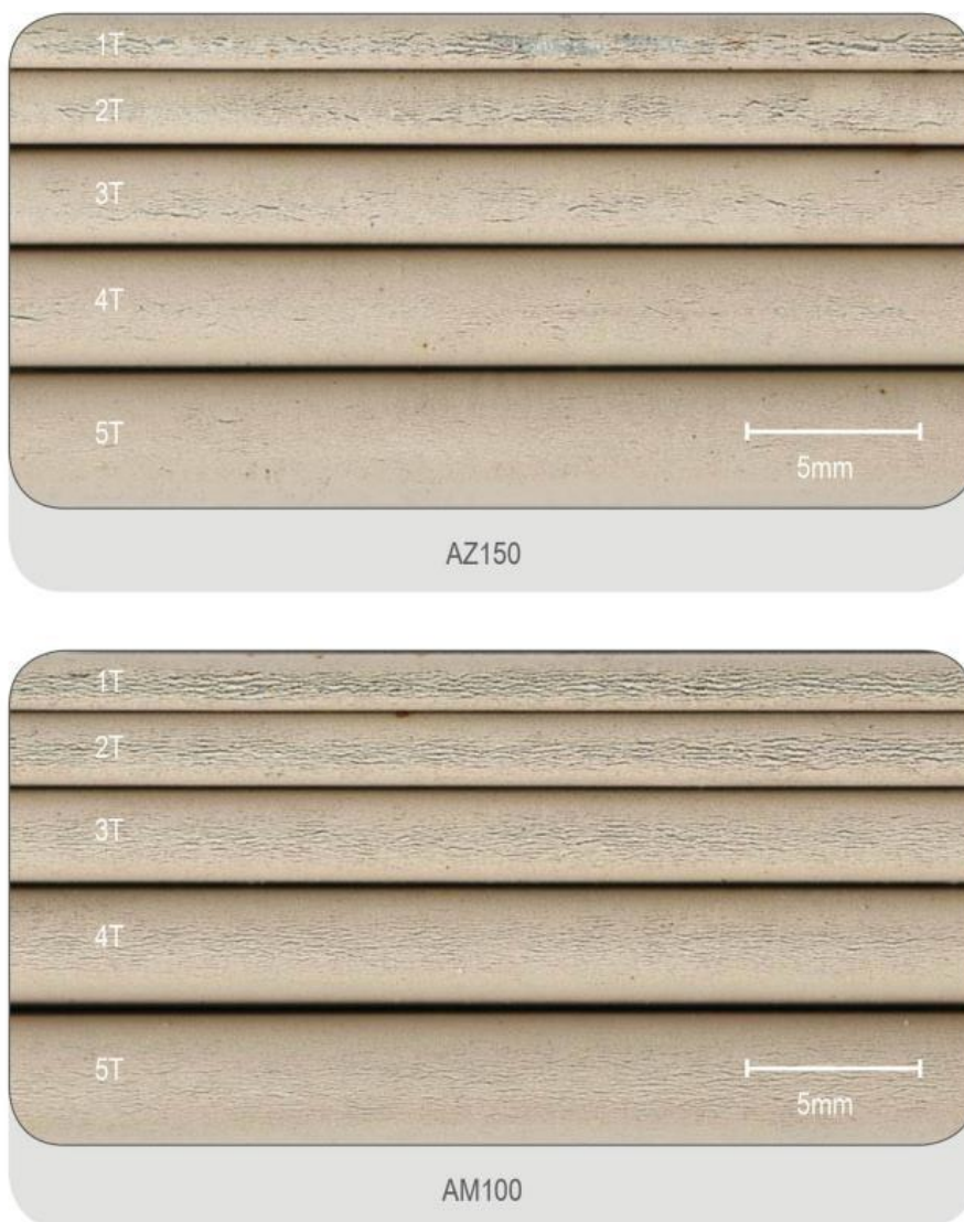
Hình 8: Các mẫu uốn cong đã được sơn phủ sẵn tiếp xúc với môi trường biển chưa rửa trong 51 tháng/ Prepainted bend samples exposed in an unwashed marine environment for 51 months.
