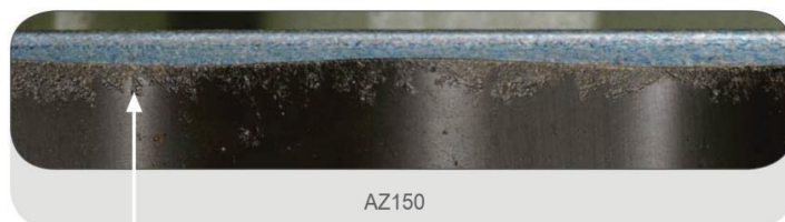
Hình 4: Tường có mái che đã sơn phủ sẵn (tức là chưa rửa) trong môi trường biển khắc nghiệt sau 50 tháng/ Prepainted sheltered walling (i.e. unwashed) in a severe marine environment after 50 months.
