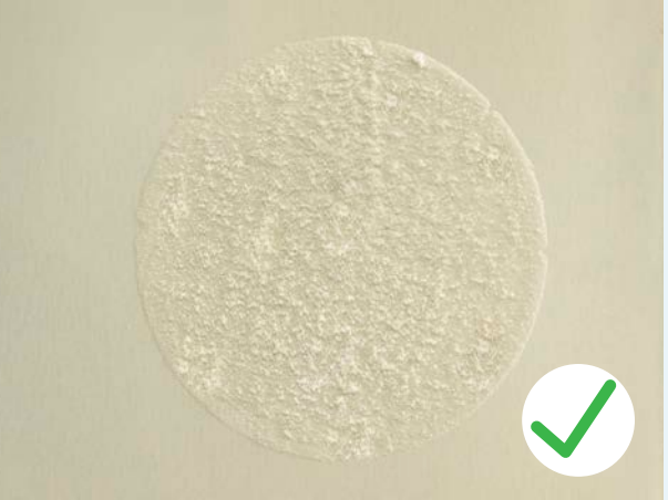
Lớp cách nhiệt bám dính tối ưu trên STICK+ FOAM Excellent insulation adhesion on STICK+ FOAM backer
