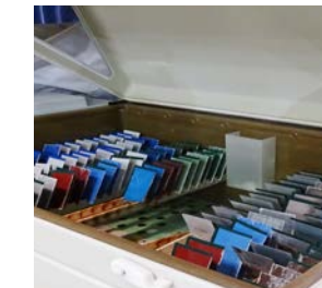
Thử nghiệm phun muối trong phòng thí nghiệm (hơn 8.000 mẫu) Accelerated Testing (>8,000 panels)
