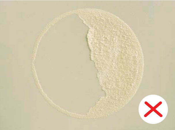
Lớp cách nhiệt bám dính trên sơn mặt sau thông thường Insulation adhesion on conventional pre-painted steel backer
