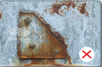
Tôn mạ 2 lớp nhôm kẽm thông thường (100g/m²) Conventional Al-Zn alloy coated steel
