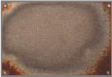
Thép ZINCALUME® công nghệ mạ nhôm kẽm (AZ) Al-Zn alloy-coated ZINCALUME® steel
